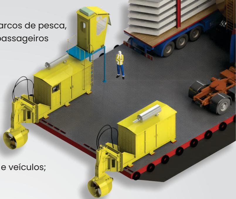
As propulsões fora de borda Strauhs são unidades propulsoras autônomas. A propulsão é integrada à unidade de potência diesel-hidráulica em um skid modular instalado no convés. O eixo da hélice é diretamente acionado por um motor hidráulico integrado à parte inferior da unidade.
