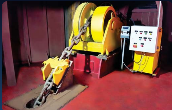
MOLINETE PORTUÁRIO INSTALADO EM PORTO FLUTUANTE EM MANAUS
