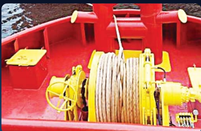
GUINCHO DE REBOQUE PELA PROA 70 TONS – CHIBATÃO
