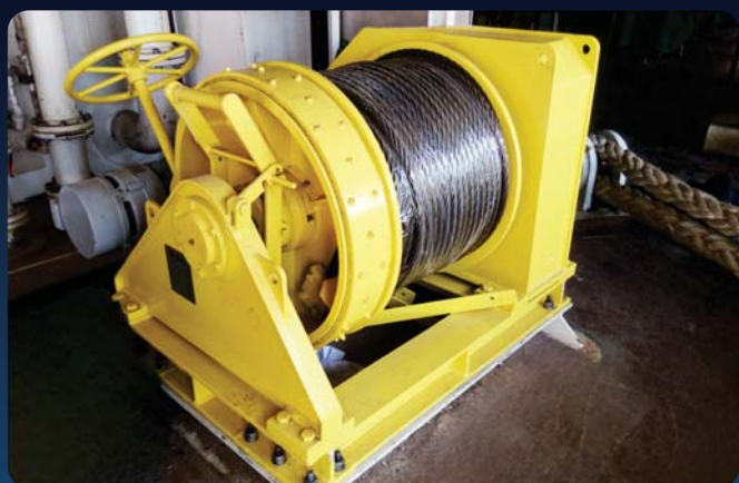
SISTEMA DE REBOQUE DE EMERGÊNCIA (GUINCHO, BUZINAS, CABEÇOS E SMIT BRACKET) PETROBRÁS P67
