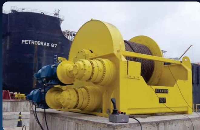
GUINCHO PARA DOCAGEM 50 TONS RIO GRANDE
