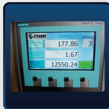
MONITORAMENTO DA FORÇA E COMPRIMENTO DO CABO
