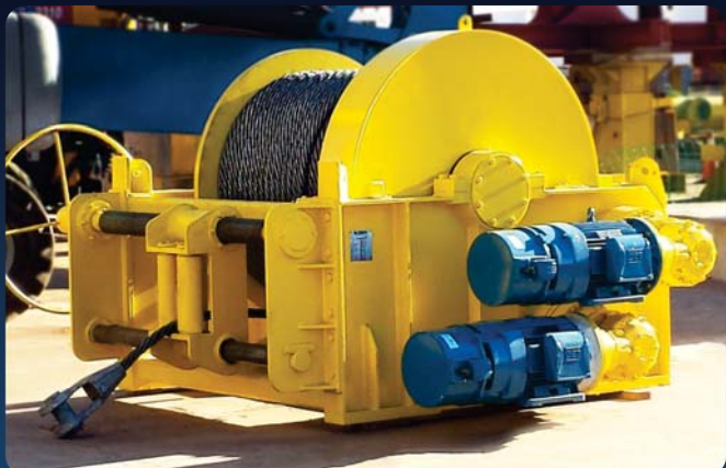
GUINCHO ELÉTRICO DE 50 TONS PARA DOCAGEM EM DIQUE SECO – RIO GRANDE
