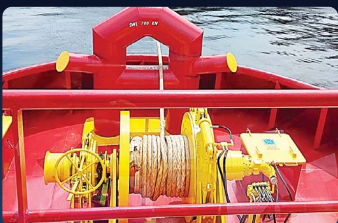
GUINCHO DE REBOQUE PELA PROA TESTE DE FRENAGEM 70 TONS
