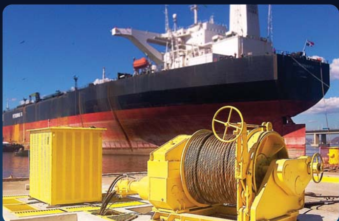
GUINCHO ELÉTRICO DE 30 TONS PARA DOCAGEM EM DIQUE SECO – RJ
