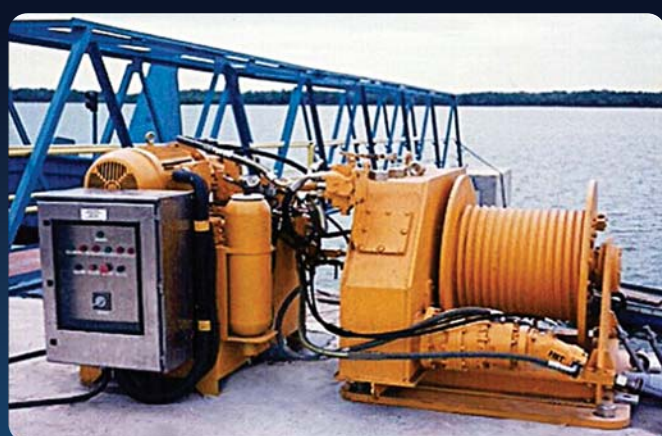
GUINCHO DE ATRACAÇÃO HIDRÁULICO DE TENSÃO CONSTANTE - VERACEL
